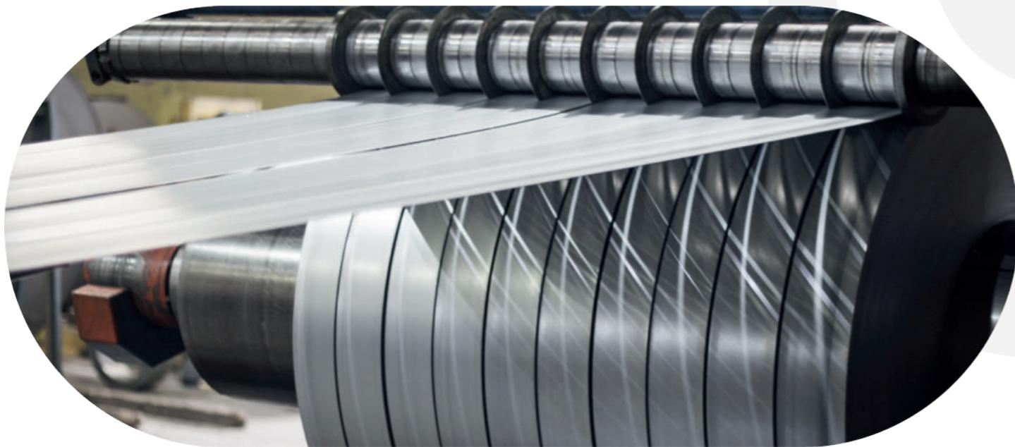
Dilme hattımızda 0,30 mm'den 15 mm kalınlığa kadar paslanmaz çelik ruloları, 10 mm genişlikteki şeritlere kadar çok düşük tolerans paylarıyla dilinebilmektedir.
