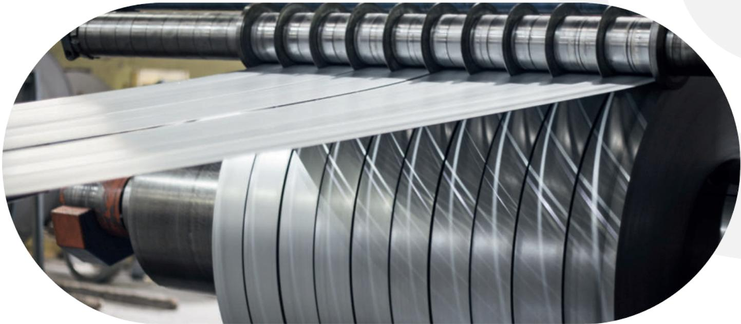
Dilme hattımızda 0,30 mm'den 15 mm kalınlığa kadar paslanmaz çelik ruloları, 10 mm genişlikteki şeritlere kadar çok düşük tolerans paylarıyla dilinebilmektedir.
